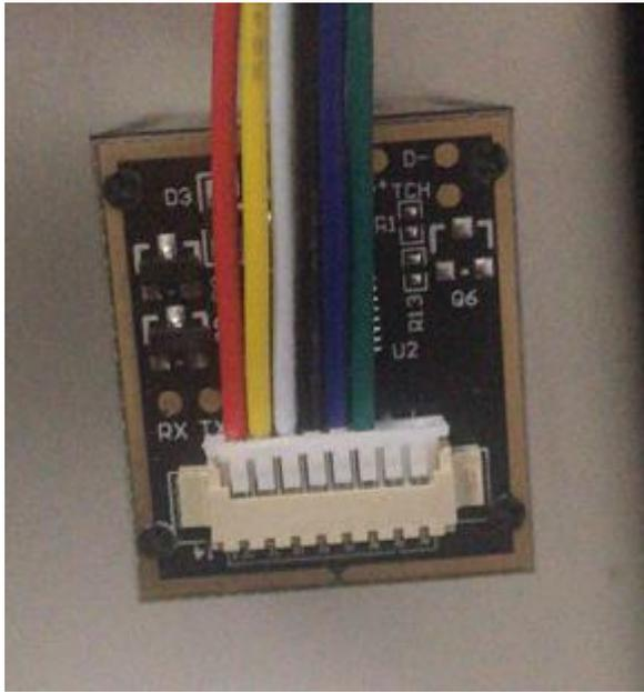
红线接 3.3V，黄线接 PIN\_64，白线接 PIN\_66，黑线接 GND，蓝绿线悬空不接：
