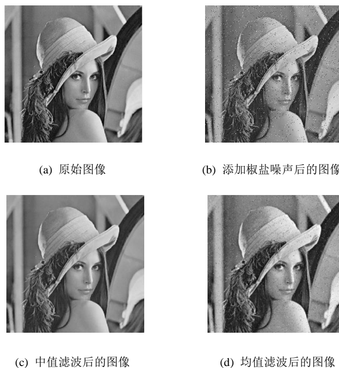
图 3-4 两种滤波算法对椒盐噪声的过滤效果对比
